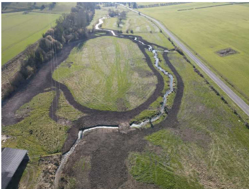
Images 93 et 94 : implantation d'ouvrages de franchissement du cours d'eau pour garantir les accès aux différentes parcelles et vue par drone ; méandrage entre les deux moulins .
